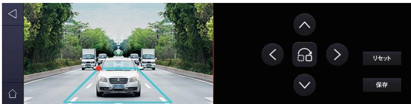
4.調整完了後に、「保存」ボタンを押して検知エリアを保存する。
