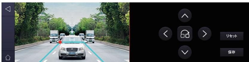
後方検知エリア調整(4箇所)
