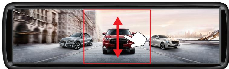
※表示中のカメラのみ調整できます。フロントカメラとリアカメラのアングル調整は連動しません。
