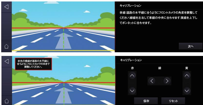
①フロントカメラの角度を上下して、画面中心を地平線に合わせます。
