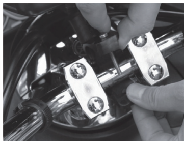
② ミラー取付け用台座のナット穴と本体のナット穴をあわせてナットを締める
