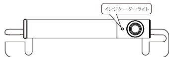
バックカメラユニット(ソーラーパネル・アンテナ内蔵)
