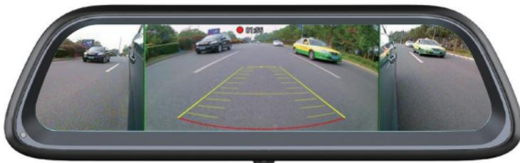
※画面表示OFFの場合でも、ウインカー/バック連動時はリア・サイドカメラ映像を表示します。
