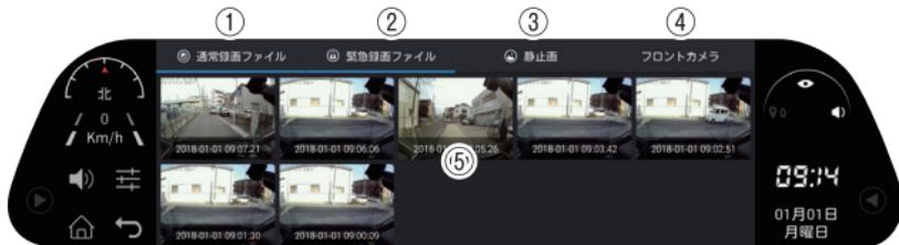
④をタッチして、フロントカメラ/リアカメラ/サイドカメラのいずれかを選択します。
