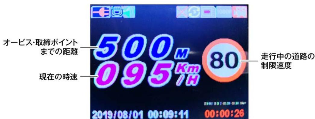
制限速度が80km/h以上の場合は約500m手前から、80km/h未満の場合は約300m手前から警告表示します。
