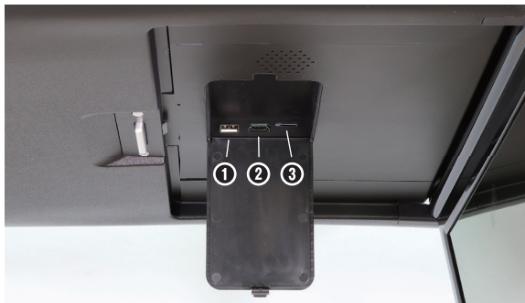
①USBポート ②HDMI【1】入力端子 ③microSDスロット
