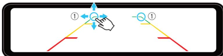
①【○】のエリアを上下スライドで赤色線の上下位置の調整・左右スライドで横線の長さを調整
