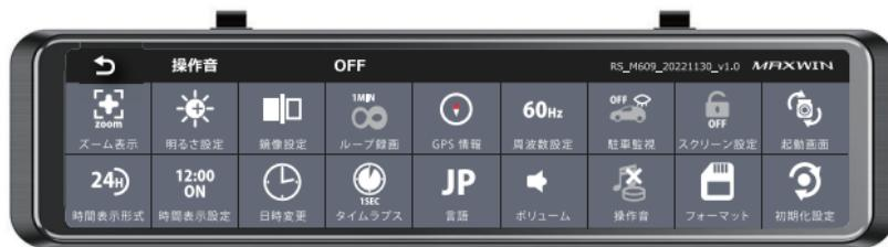
《ズーム表示》リアカメラのズーム表示の設定をします。(+1段階～+10段階)
